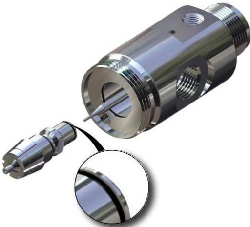
5. Flüssigkeitseinsatz [20] aus Düsenkörper [10] von Hand herausziehen. O-Ring [21] des Flüssigkeitseinsatzes auf Beschädigungen prüfen, ggf. ersetzen.
