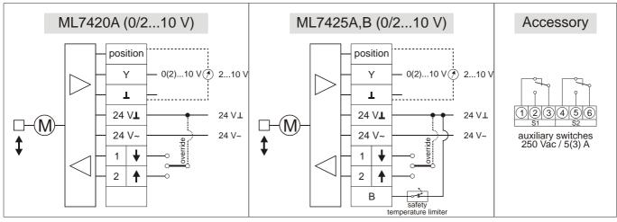
Fig. 3. Wiring
